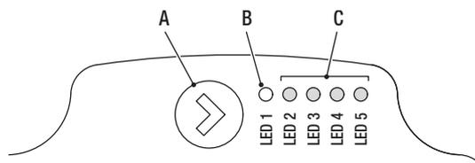
L'interfaccia utente permette di visualizzare le prestazioni in funzionamento (stato funzionamento e stato allarme) e impostare le modalità di funzionamento del circolatore. Le prestazioni, indicate dai LED (B) e (C) sono sempre visibili durante il normale funzionamento del circolatore mentre le impostazioni si effettuano con la pressione del tasto (A).
