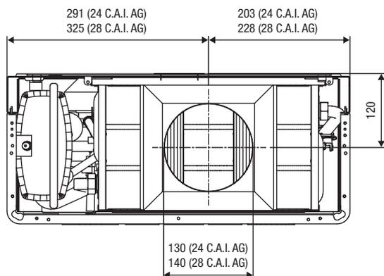
La figura riporta la vista dall'alto della caldaia con le quote di riferimento per l'interasse dell'uscita fumi, rispetto alla piastra di supporto caldaia.
